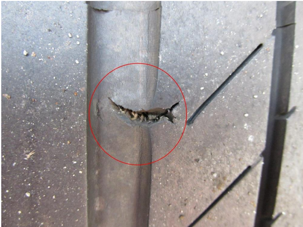
10 : Reifen hinten rechts beschädigt
